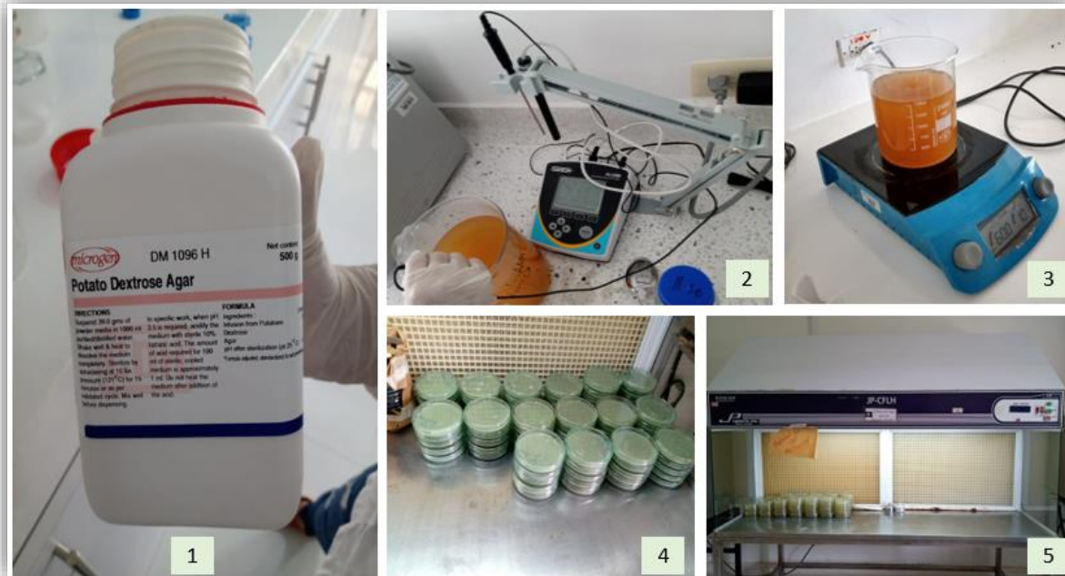
Ilustración 5. 1. Medio nutritivo PDA. 2. Mediciones con pH-metro. 3. Plancha de calentamiento. 4. Cajas Petri con medio nutritivo. 5. Cabina de flujo laminar.
