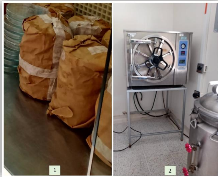
Ilustración 4. 1. Cajas Petri empacadas para esterilizar en Autoclave. 2. Autoclave
