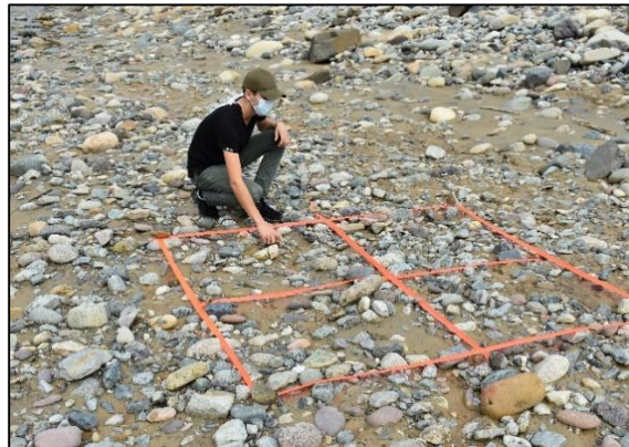
FIGURA 19. Análisis granulométrico y geoestadístico en el sector del Pailón por el método de granulometría in situ.
