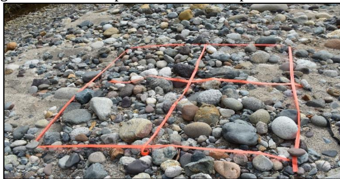
FIGURA 16. Granulometría In situ en el sector de las juntas por el método de cuarteo y análisis geoestadístico.
