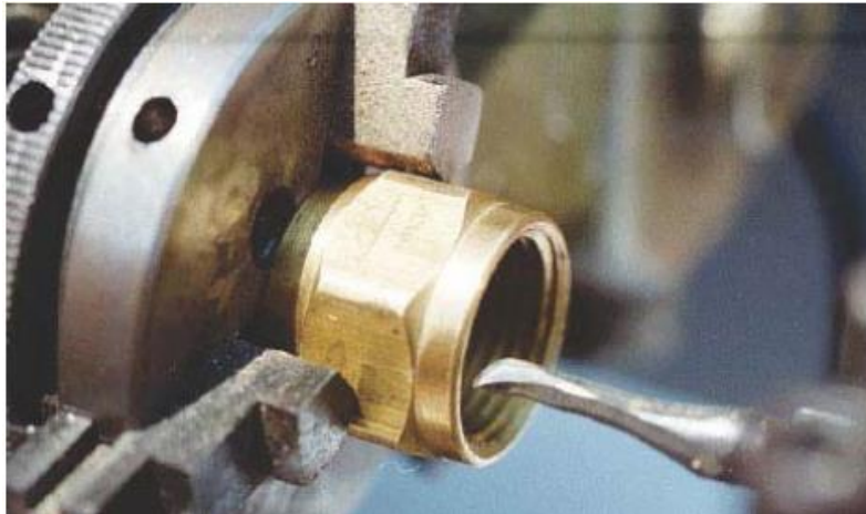
Figura 40. Eliminación de la rosca de la tuerca cónica
