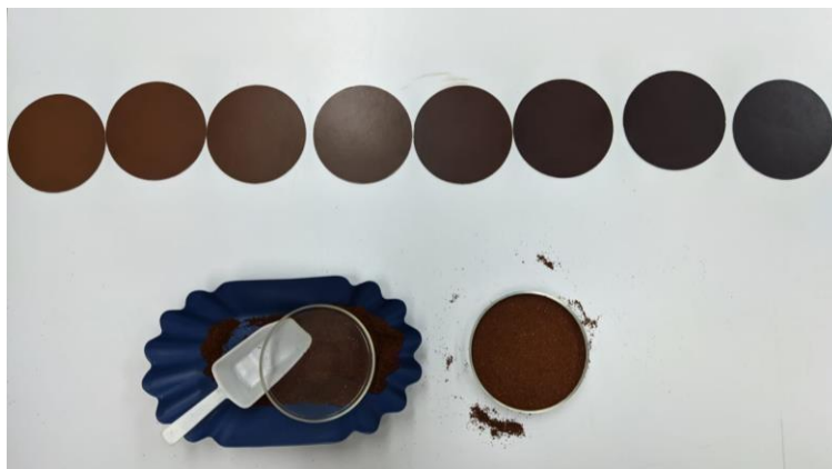
Figura 2: Escala Agtron Gourmet (Sistemas con discos Agtron para clasificación subjetiva).
