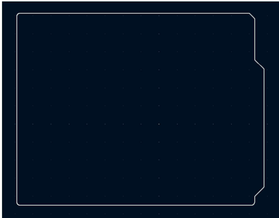
Figura 11. Líneas externas de corte de la placa de desarrollo de Arduino, basada en sus archivos originales.
