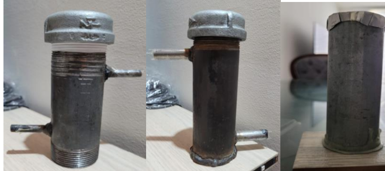
Figura 24. Tanques fabricados de hierro y acero al carbón.
