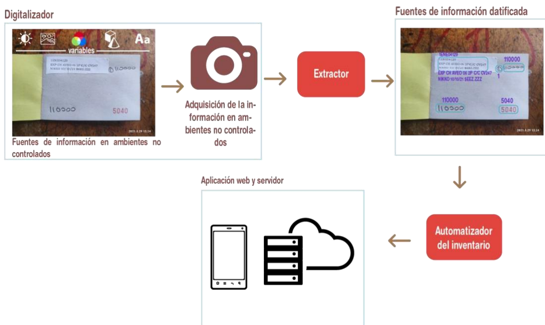
Ilustración 1. Relación entre los componentes y procesos del Sistema de Digitalización de Texto.
