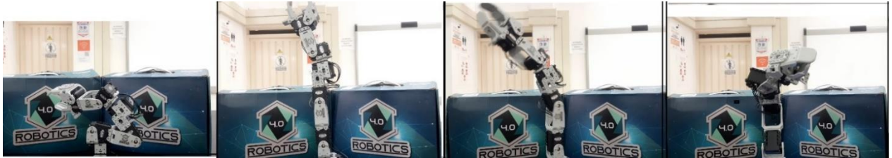
Figura 59. Movimiento en OpenBotv v1 aplicando el método de Spline Cúbico
