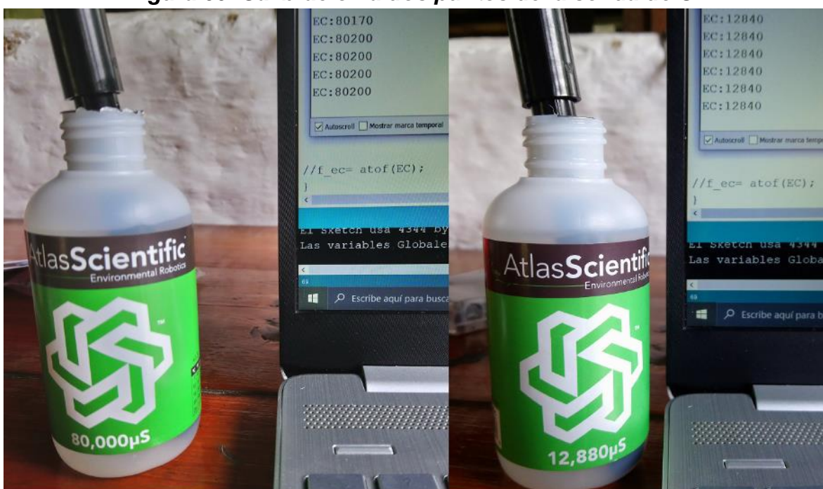
Figura 60. Calibración a dos puntos de la sonda de CE
