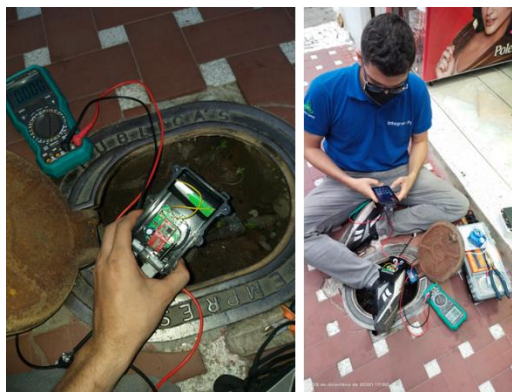
Figura 25: Verificación niveles de voltaje de dispositivo de agua antes de ser instalado
