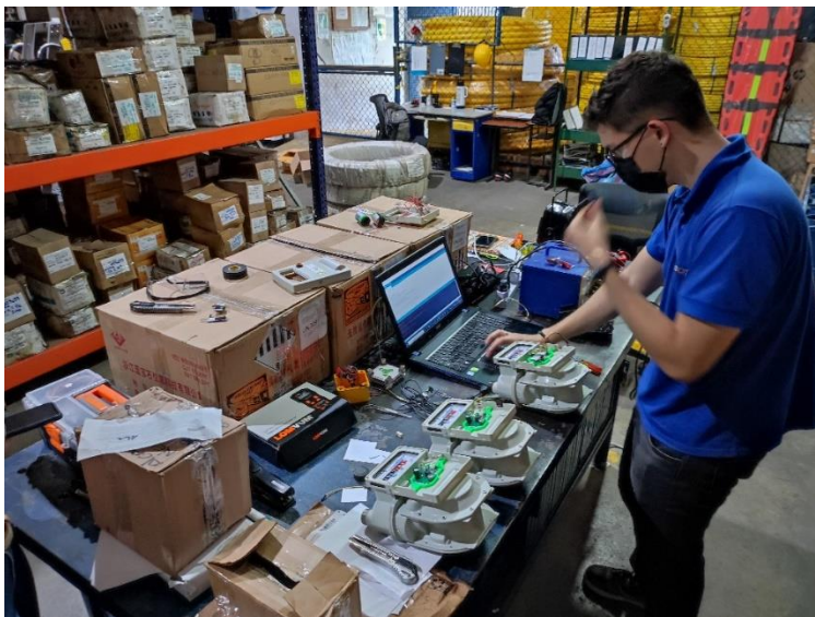
Figura 39: Verificación de las lecturas de los medidores de gas luego de la reparación
