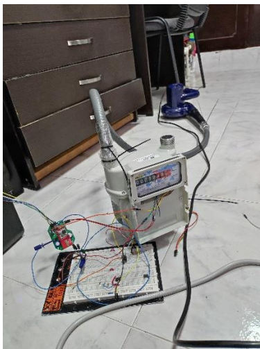
Figura 29: Pruebas en laboratorio con el medidor de gas pre equipado y el dispositivo GreenyWave
