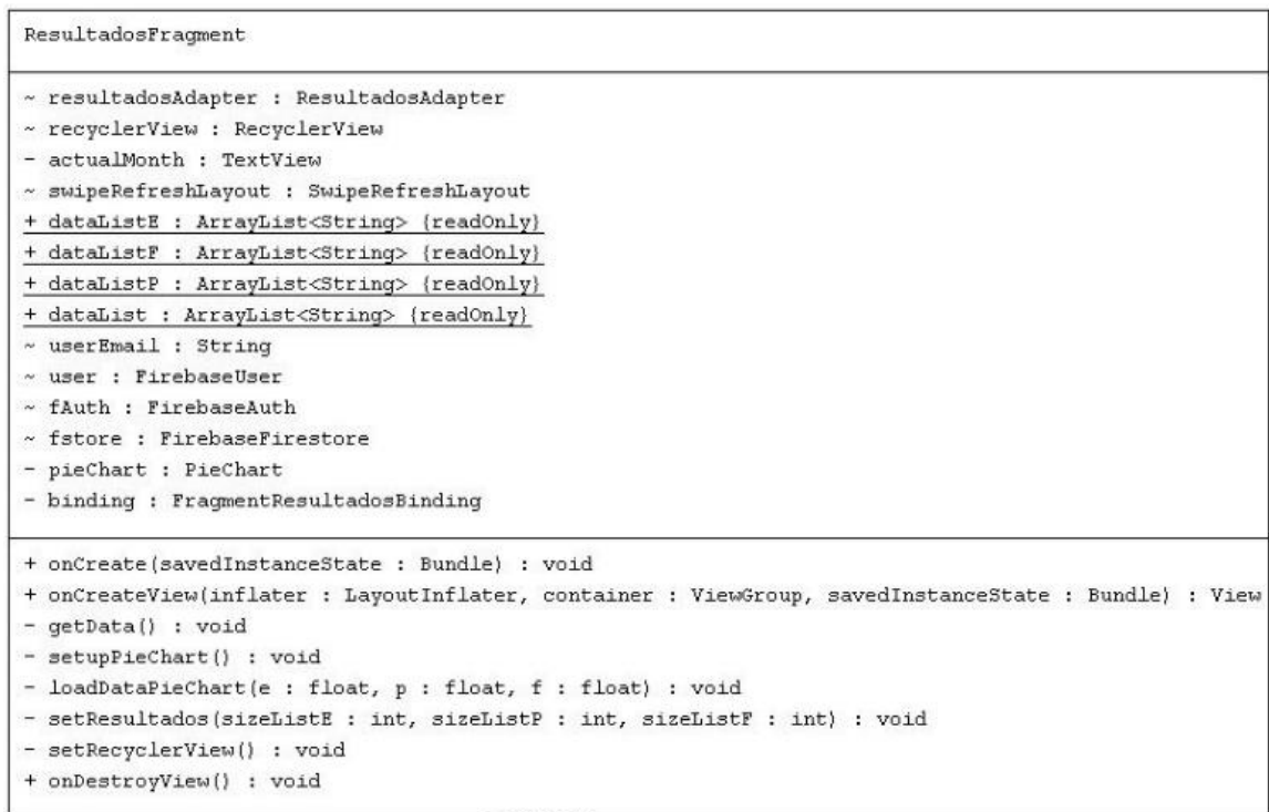
Figura 37. Diagrama UML del Fragment Resultados.
