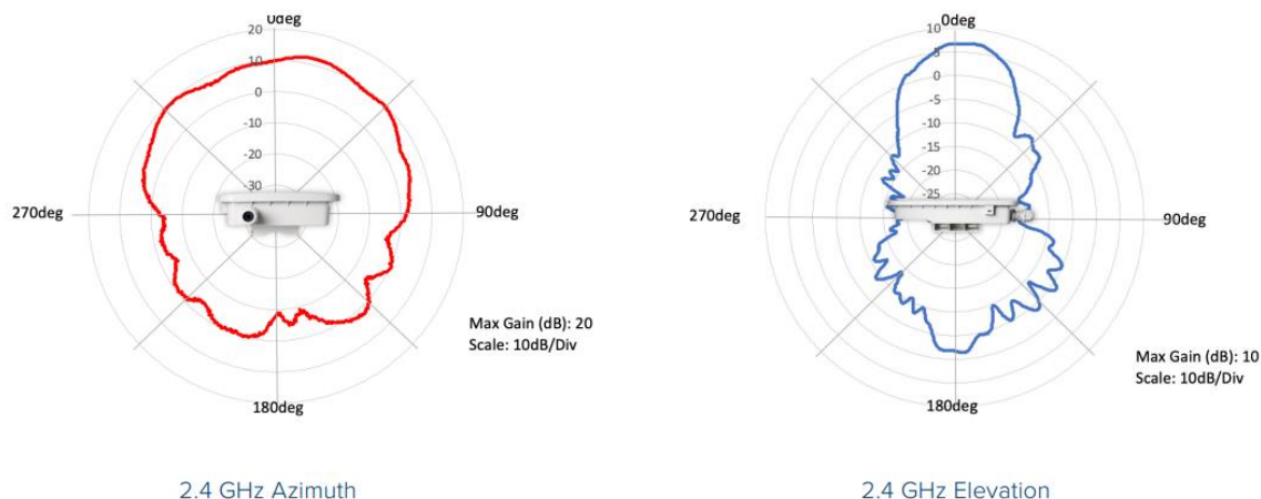
Figura 5. Diagrama de radiación AP cnPilot E510 outdoor a 2.4 GHz
