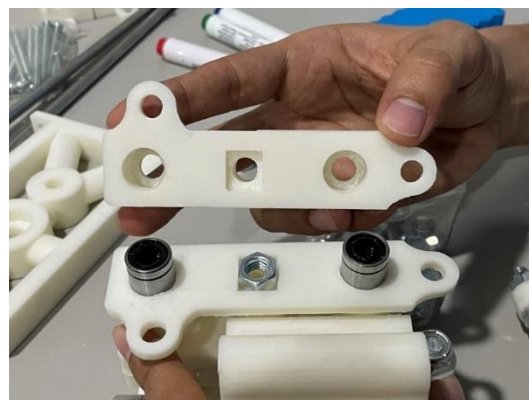
Figura 62. Acoples de eje encajados en la pieza fabricada
