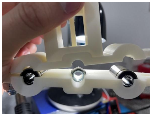
Figura 63. Acoples del eje Z encajados en el riel del soporte del servomotor
