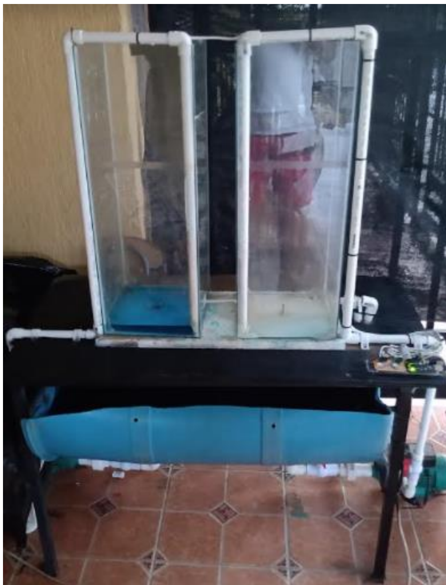
Figura 25. Montaje final del sistema de tanques acoplados
