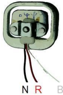
Figura 12 - Celda de carga
