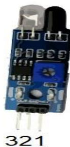
Figura 13 - Sensor de proximidad infrarrojo
