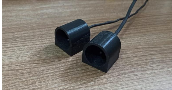
Figura 15. Implementación del caso 4. Sensores receptores.
