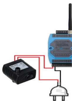
*Nota:* La activación de la bomba de agua se hizo mediante el uso de los relés RO1.
