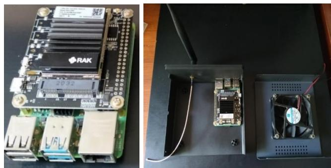
*Nota:* La imagen de la izquierda corresponde al acople entre el RAK2287 Pi Hat y la raspberry Pi. La imagen de la derecha corresponde al interior del Gateway desarrollado, el cual cuenta además con una antena y un ventilador de 12 mm para la disipación del calor en la placa. *Fuente:* Autores.
