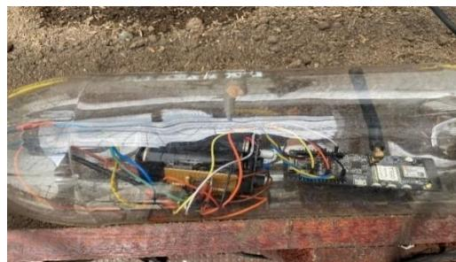
*Nota:* La imagen indica la conexión eléctrica (al interior de una botella de plástico) entre la tarjeta Wifi TTGO t-Beam junto con el dispositivo acondicionador de señal. *Fuente:* Autores
