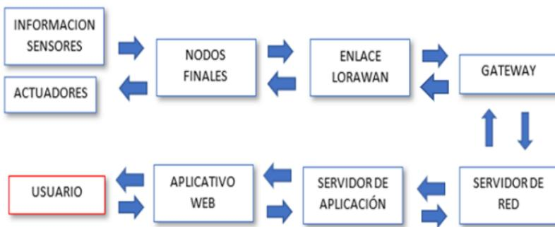
*Nota:* En esta figura se observa que la implementación de ChirpStack permite establecer comunicación bidireccional entre los nodos finales y el Gateway, por lo que además de visualización de información, el usuario establece la toma de decisión de acuerdo con su criterio. *Fuente:* Autores.
