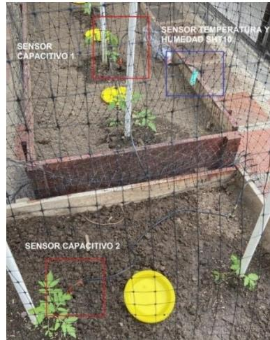
*Nota:* El recuadro de color rojo indica la posición del sensor capacitivo en cada huerta, mientras que el recuadro azul indica la posición del sensor SHT10. *Fuente:* Autores.
