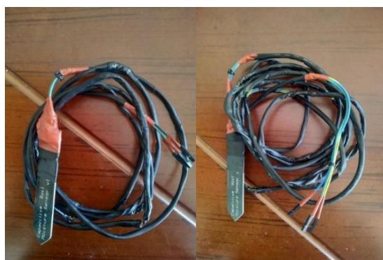
*Nota:* Esta imagen indica el aislamiento de los sensores capacitivos mediante cinta termo encogible y cinta aislante. *Fuente:* Autores.
