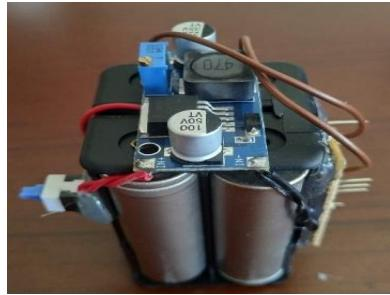
Nota: Circuito amplificador de señal conectado al regulador de voltaje y sus baterías de litio como fuente de alimentación. *Fuente:* Autores.
