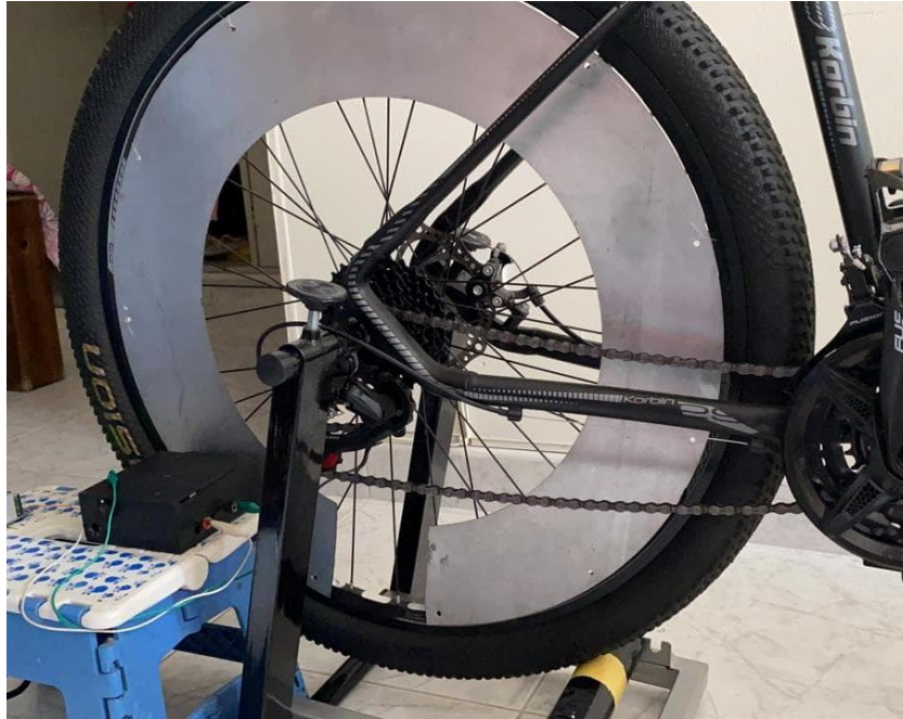
Ilustración 5. Sistema de freno magnético.
