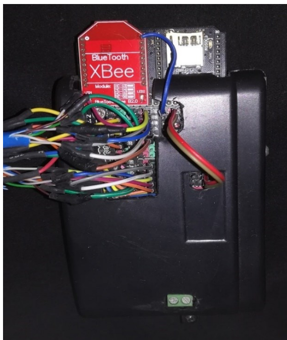
Figura 52. Presentación exterior de controlador, placa DF-ROBOT + Xbee
