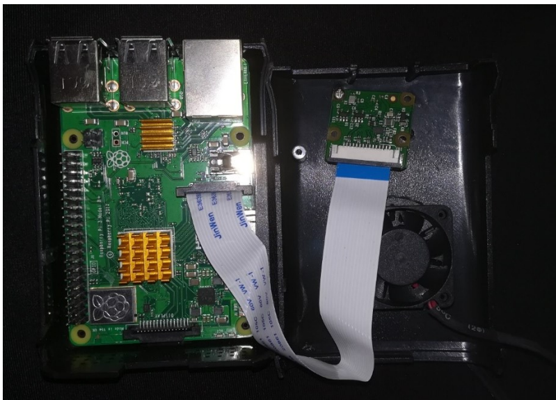
Figura 53. Caja negra para montaje interno Raspberry + Cámara+ Extractor
