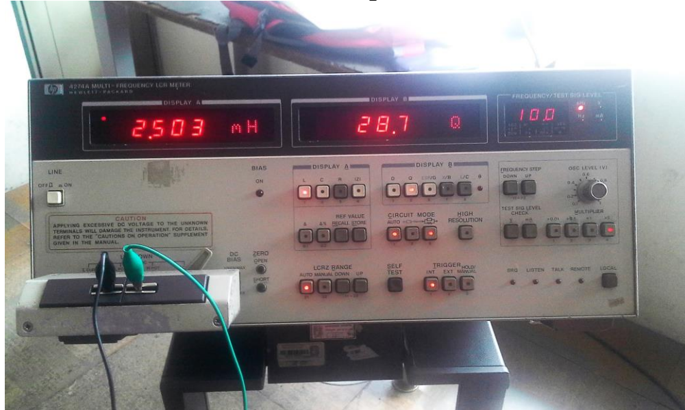
Figura 14. Multifrecuencímetro LCR HP 4274A, en propiedad de la Universidad Distrital Francisco José de Caldas, sede Bogotá.
