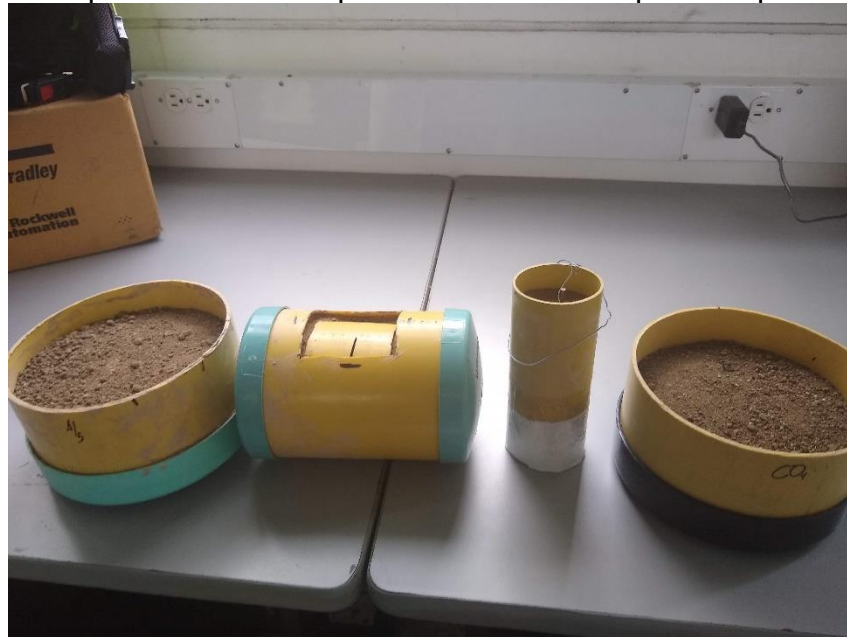
Figura 30. Prototipos de minas antipersonal elaboradas para las pruebas de campo
