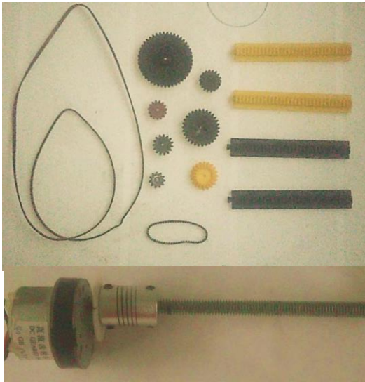
Figura 2. Sistemas transmisión de movimiento analizados. Arriba (Lineal): Correas, ruedas dentadas y engranajes de cremallera. Abajo (Rotacional): Acople, Varilla milimétrica y tuerca.
