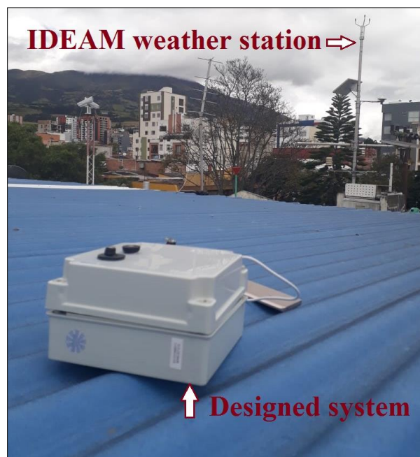
Figura 56. Validación del sistema con estación meteorología del IDEAM
