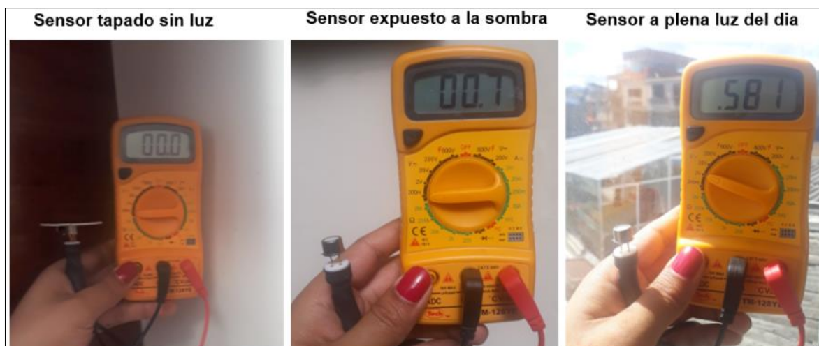
Figura 33. Lectura del voltaje de salida en diferentes exposiciones de luz.
