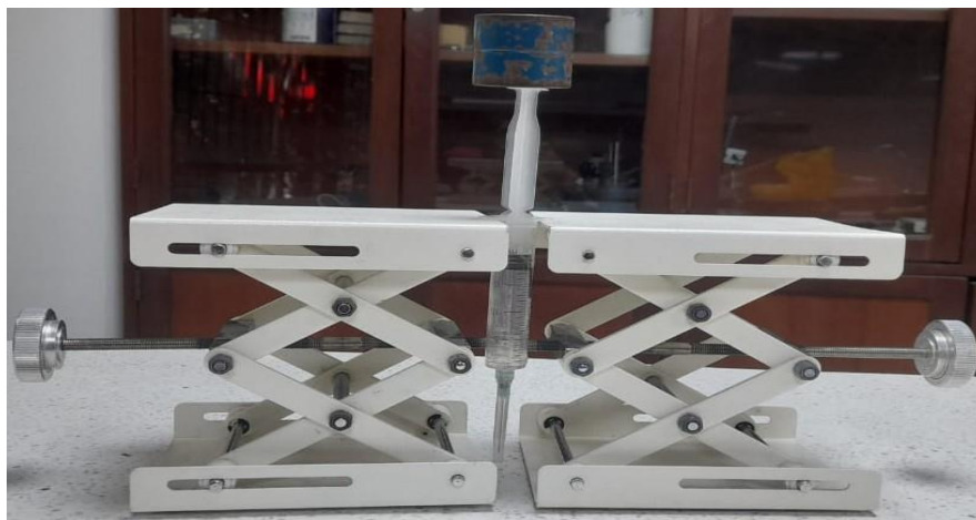
Figura 5: Prueba experimental de la compresión del aire en la jeringa
