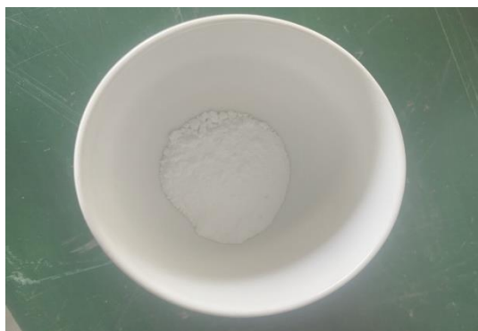
Figura 7: Polvo obtenido tras la homogeneización manual de los reactivos de partida, MgO y H 3 BO 3 , y dopante Ce 2 O 3 .
