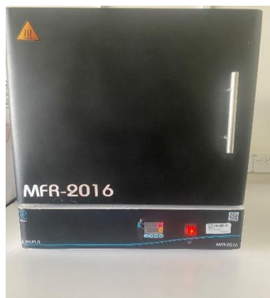
Figura 8: Horno utilizado para calcinación, sinterización y tratamientos térmicos para reutilización de compuestos. MFR-2016.
