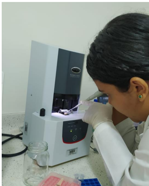
Figura 6. Cuantificación de ADN a través de espectrofotometría, utilizando el equipo Nanodrop 2000 .
