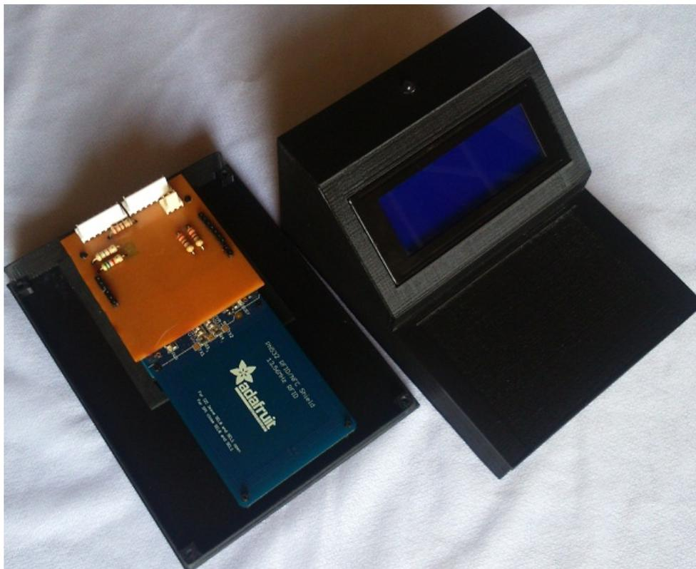
Figura 3.6: Montaje del lector de etiquetas NFC
