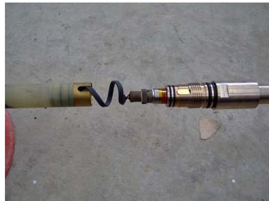
Figura 22. Conexión entre la G4 y la Batería
