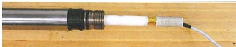
Figura 37. Conexión entre (Gamma Ray CSGx interface) y Sonda de rayos gamma
