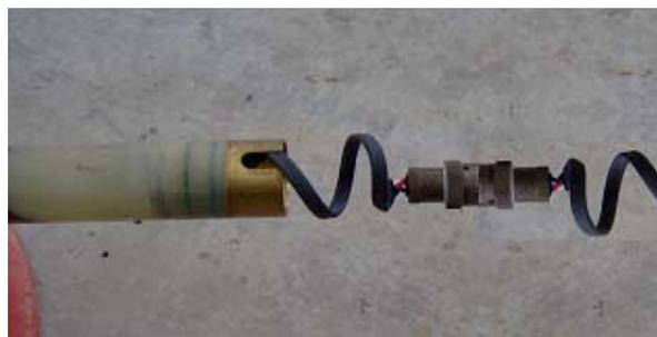
Figura 38. Conexión entre (Gamma Ray CSGx interface) y batería de litio
