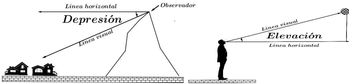
Figura 6.1. Ángulos de elevación y depresión
