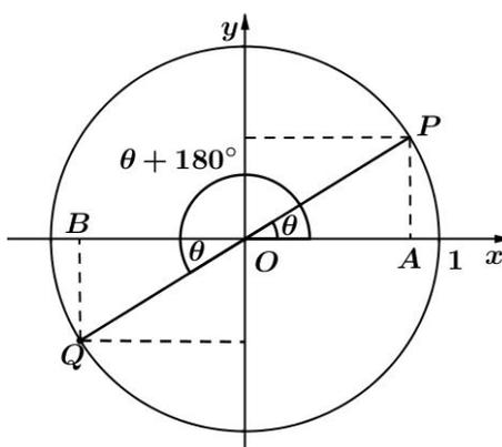
Figura 2.18. Funciones trigonométricas de  $180^\circ + \theta$
