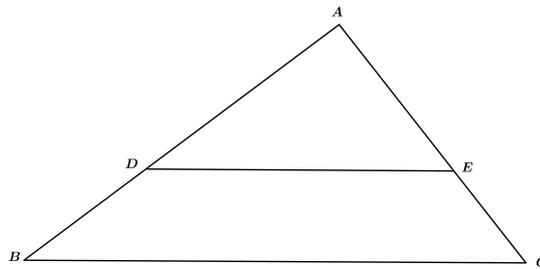
Figura 1.10. Triángulos semejantes determinados por una paralela
