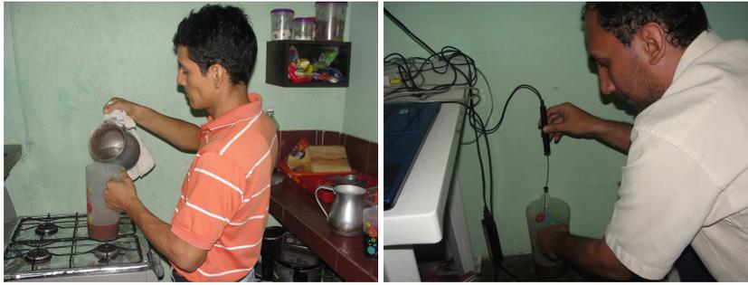
La siguiente imagen muestra la ubicación de la bebida caliente en un recipiente de plástico, la sonda y el computador.
