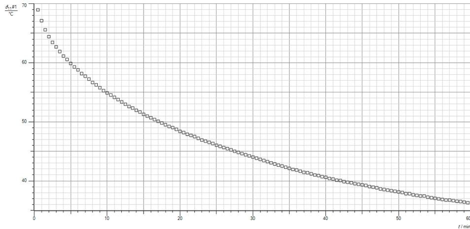
Basándose en los datos de la imagen de la función obtenida, tomando la temperatura ambiente de  $24^{\circ}C$  y una temperatura inicial de  $71,5^{\circ}C$  se plantea la ecuación diferencial
