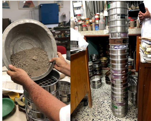
FIGURA 15. Procedimiento para la separación de partículas del suelo mediante el método de tamizado.
