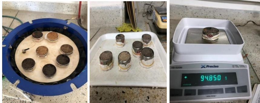
FIGURA 11. Obtención de la densidad aparente mediante el método del cilindro de volumen conocido.
