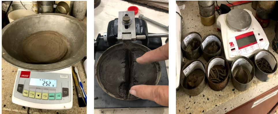
FIGURA 16. Se procedió agregar o retirar agua de las muestras de suelo y posteriormente se mezcló hasta que se obtuvo una pasta semi-líquida homogénea en términos de humedad, determinando el límite de Atterberg.
