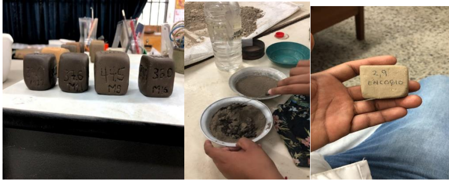
FIGURA 18. Formación de cubos para determinar la retracción de la muestra.
