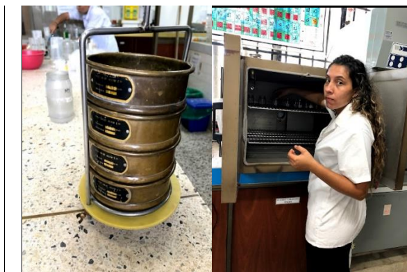
FIGURA 14. Procedimiento de tamizaje de cada muestra de suelo y secado de estas al horno.
