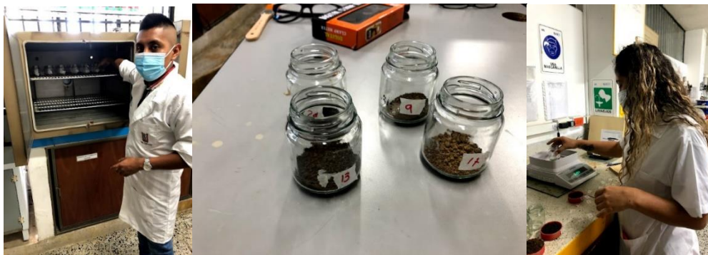
FIGURA 4. Procedimiento para determinar la perdida de humedad de las muestras secadas al horno.
