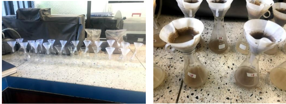
FIGURA 8. Proceso de filtración para la obtención de la conductividad eléctrica.
