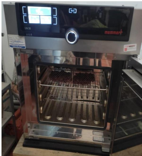
*Figura 9. Determinación de la humedad inicial mediante el método de la estufa.*
