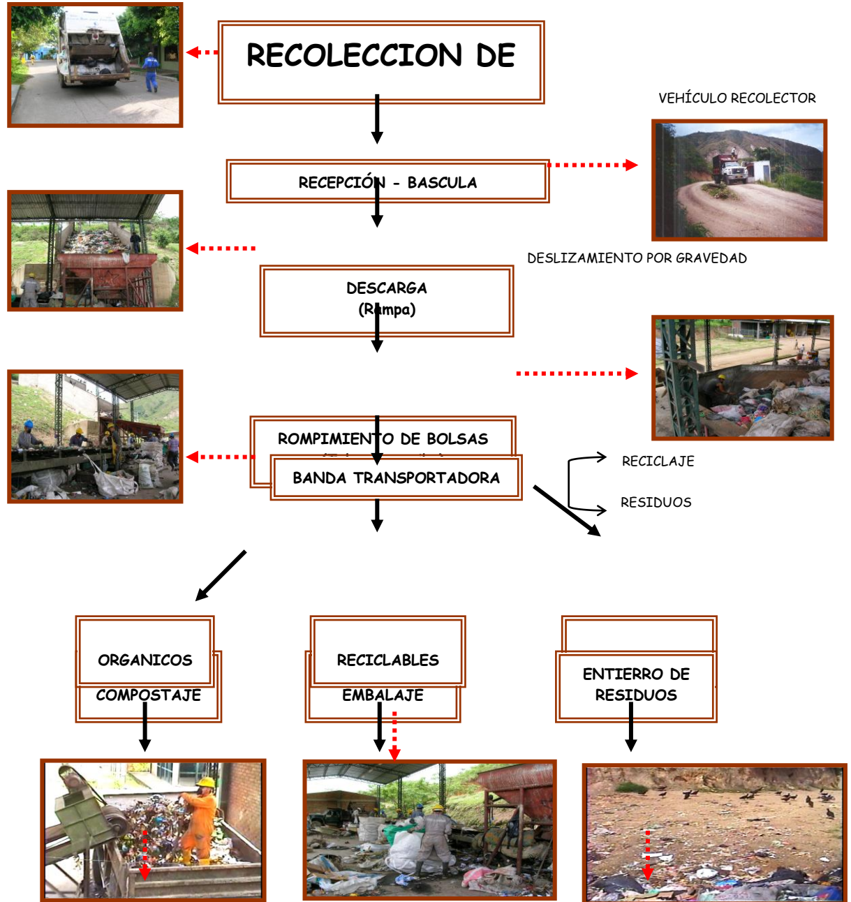
Figura 4. DIAGRAMA DE FLUJO DEL PROCESO DE DISPOSICION FINAL DE RESIDUOS SÓLIDOS. Empresa Biorgánicos del Centro del Huila S.A.E.S.P. Planta de Tratamiento de Residuos Sólidos. Garzón 2008
