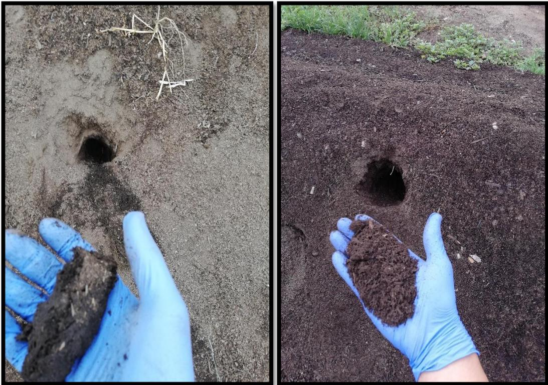
Técnica manual o de puño usada para la determinación de humedad.
