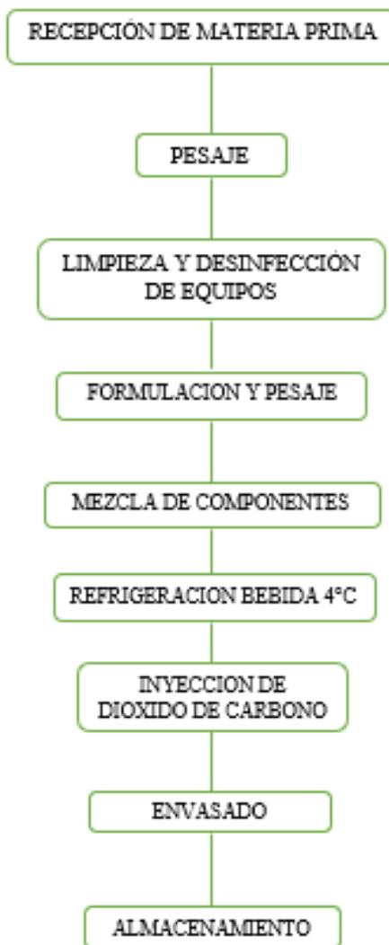
Figura 2. Diagrama de bloques para el proceso de elaboración de bebida refrescante.
