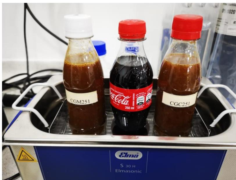
Figura 10. El contenido de dióxido de carbono disuelto en la bebida se determinó utilizando el equipo Elmasonic S30H.
