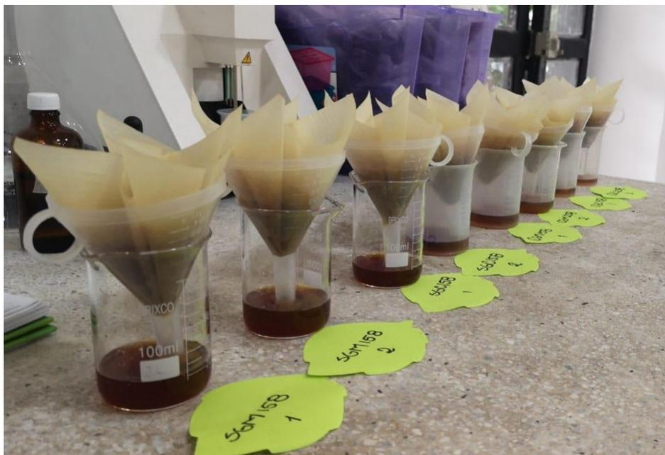
Figura 11. Procesamiento de bebida, para análisis de vida útil en almacenamiento.
