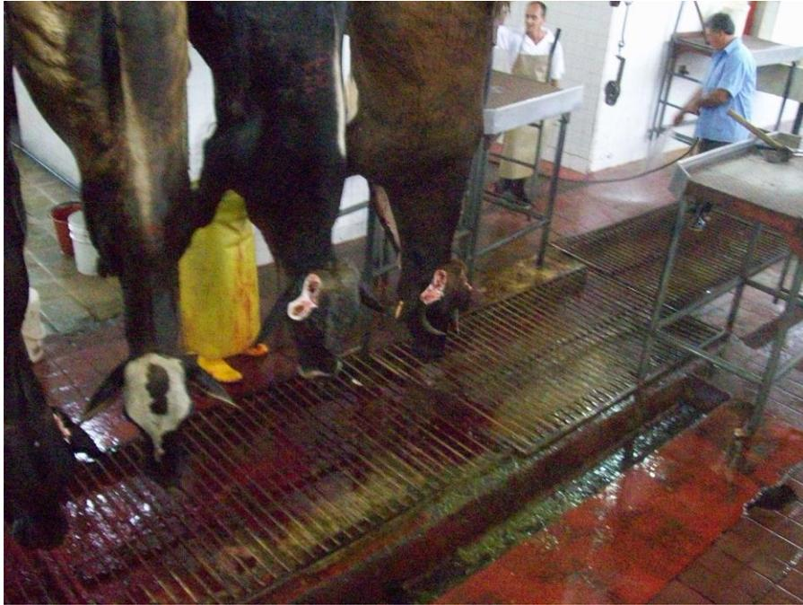
Figura 27. Tapas en mal estado.
