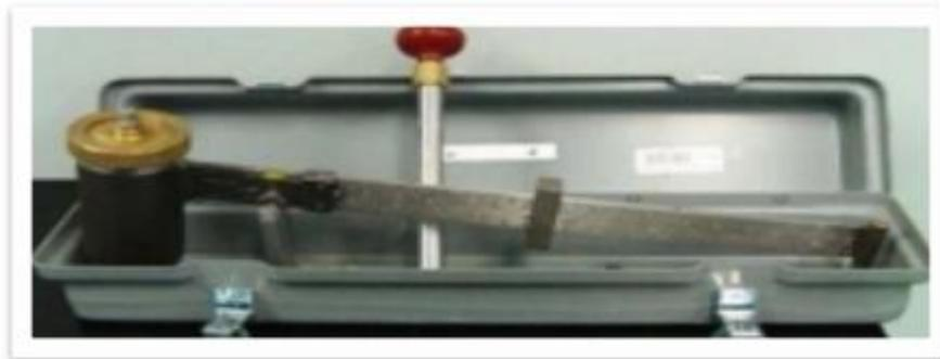
**Nota:** Esta imagen representa la balanza presurizada para ensayos de perforación de lodos, con sus respectivas partes. Tomado de (Salazar f., 2015)
