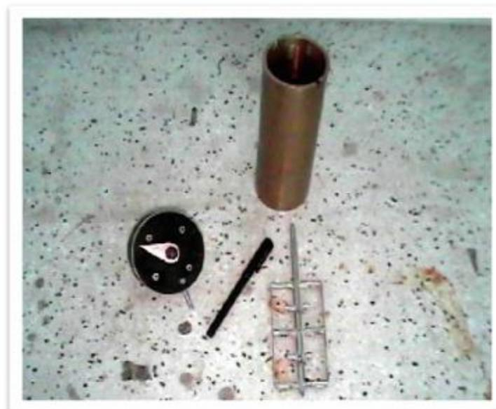
**Nota:** Esta imagen representa los componentes cilindro, paletas y tapa medidora del toque
