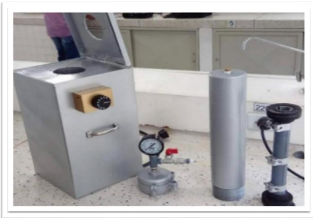
**Nota:** Esta figura hace representación del principio del método de Arquímedes, que es utilizado para la prueba del asentamiento de la lechada. Tomado de (Salazar f., 2015
