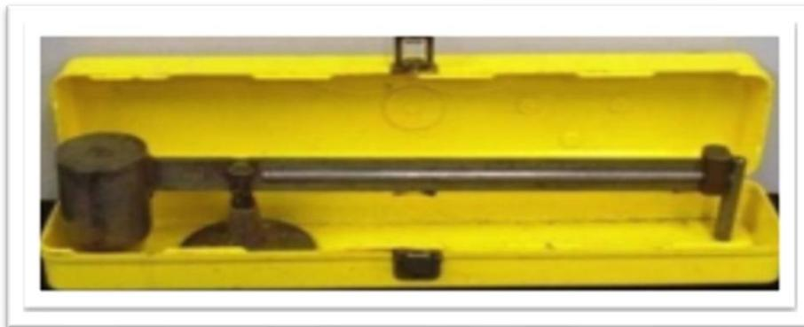
**Nota:** Esta imagen representa la balanza de lodos para lodos de perforación, con sus respectivas partes. Tomado de (Gomez Patiño P, 2017)
