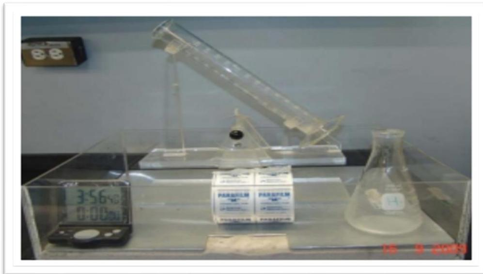
**Nota:** Esta imagen representa una simulación de un pozo horizontal a 45°, para simular las condiciones que se dan en los pozos. Tomado de (Gomez Patiño P, 2017)
