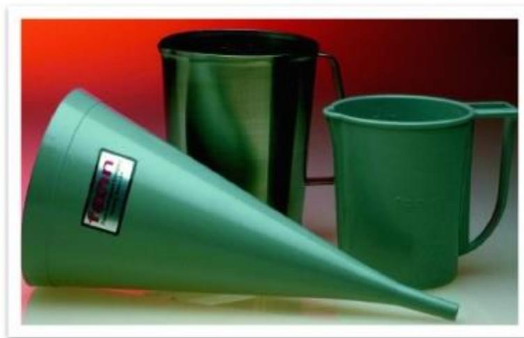
**Nota:** Esta imagen representa el equipo de viscosidad de Marsh, usado para calcular la viscosidad de los fluidos de perforación (lodos). Tomada de (Gomez Patiño P, 2017)
