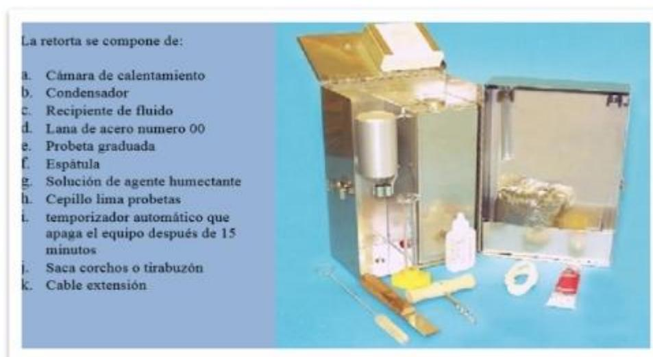
**Nota:** Estas figuras contienen el equipo para la determinación del ensayo de la Retorta.
