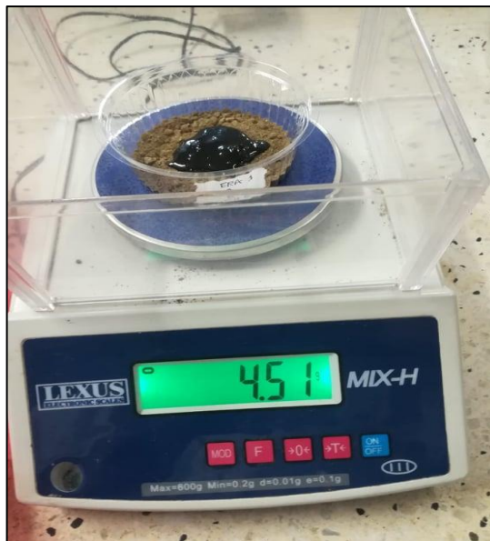
Ilustración 4. Adición de borra en el suelo dispuesto a contaminar
