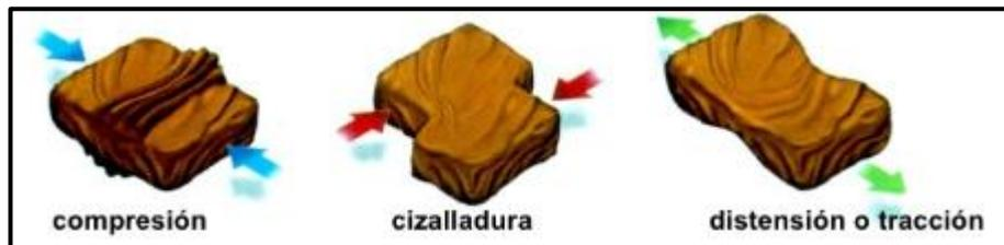
**Figura 1.** Tipos de esfuerzos (a) tensión, (b) cizalladura, (c) tensión o tracción
