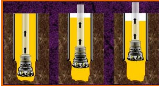
Figura 12. Llenado insuficiente del hueco.
