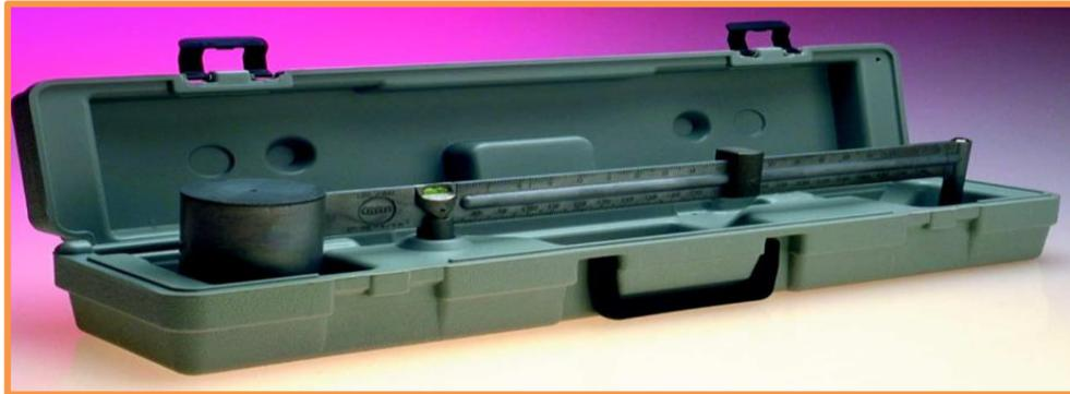
Figura 17 . Balanza para medir la densidad del fluido de perforación. Fuente: (WCS Well Control School, 2003, pág. 210)
