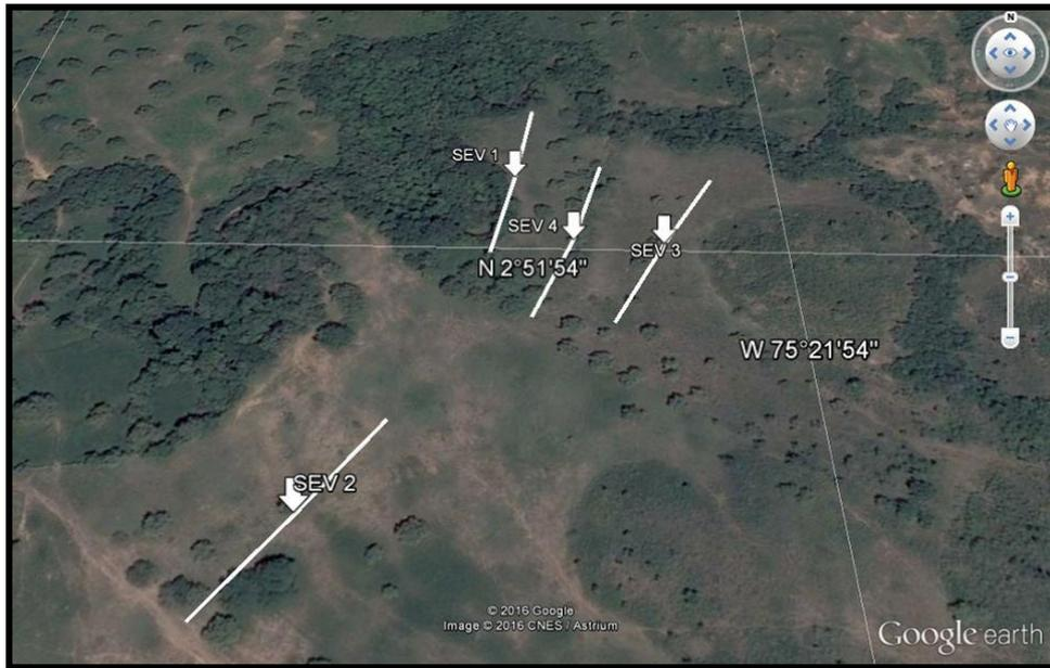
*Figura 58. Ubicación y orientación de los Sondeos geoelectricos.*
