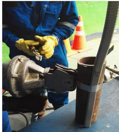
Figura 8. Prueba de funcionamiento de Zunchadora Neumática, donde se determinó que operativamente está en excelente estado.
