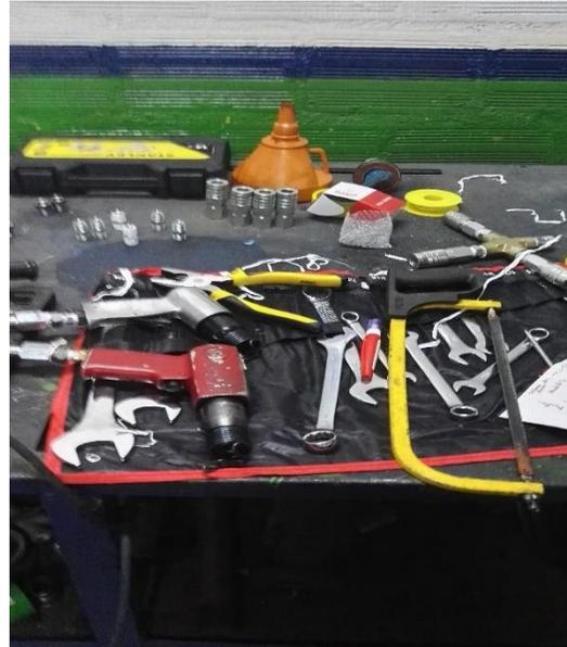
Figura 4. Verificación del funcionamiento de los martillos neumáticos y adaptación de las conexiones rápidas (pin – box) para conectar a las mangueras de presión.
