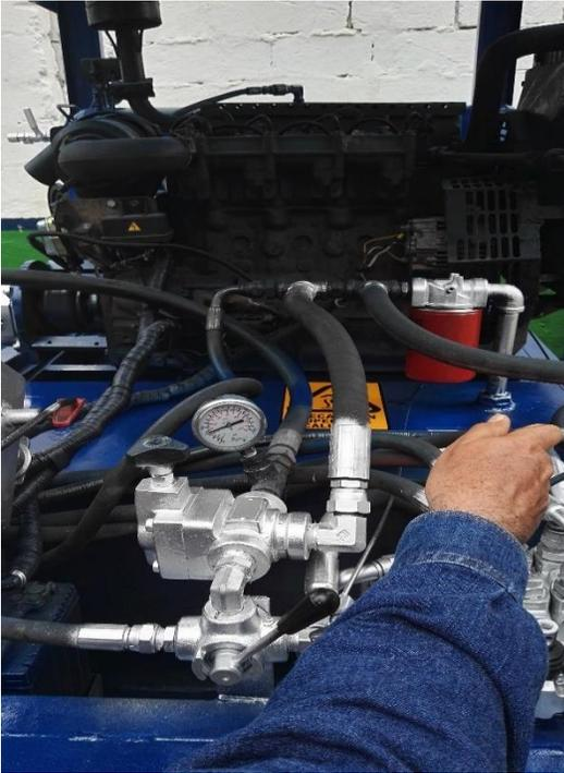
Figura 3. Prueba al sistema hidráulico del equipo Spooler y verificación de presión con la que trabaja el equipo.
