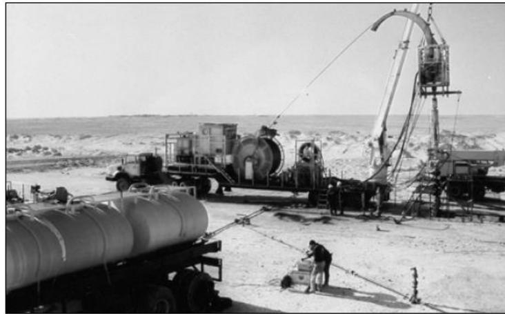
*Figura 1. Tratamiento de estimulación matricial usando una unidad de coiled tubing, bomba de camión y transporte de fluidos. Fuente: Economides M. J. & Nolte K. G. (2000).*
