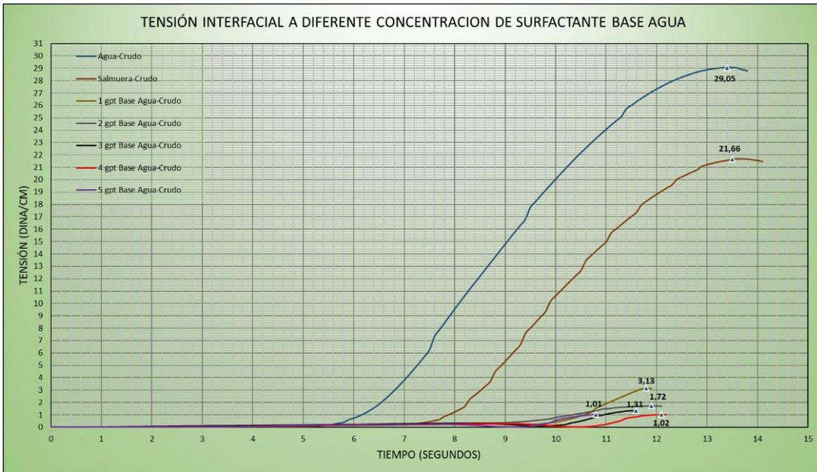
Figura 22. Reducción de la tensión interfacial por acción del surfactante base agua. Fuente: Autores (2018).
