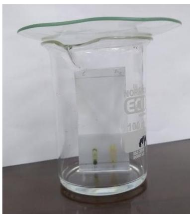
**Figura 22.** Montaje de la placa cromatográfica en capa fina. Tomada el 21 de febrero del 2022
