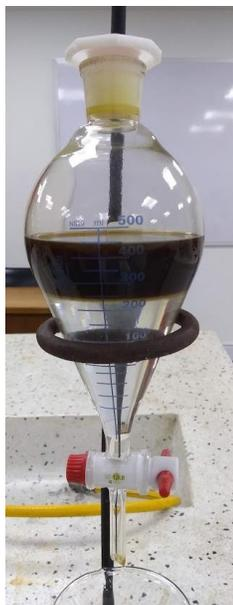
**Figura 19.** Montaje para la separación líquido-líquido con cloroformo. La fase acuosa es de color oscuro (arriba) y la orgánica es traslúcida (abajo). (Fuente propia)
