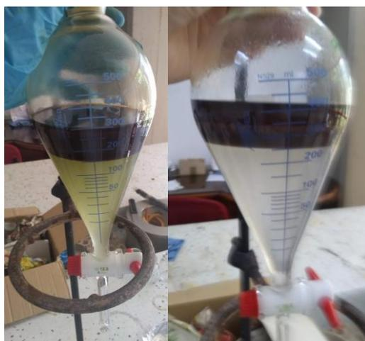
**Figura 15.** Extracción líquido-líquido para la separación de los alcaloides. (Fuente Propia)
