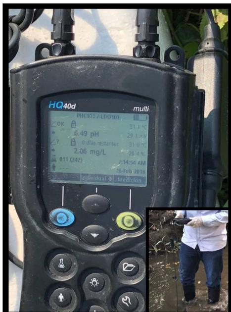
**Figura 6.** Medición de parámetros fisicoquímicos con el pHmetro digital portátil HQ40d
