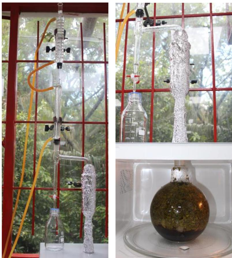
Figura N° 5. 11. Montaje para la hidrodestilación simple asistida con microondas.
