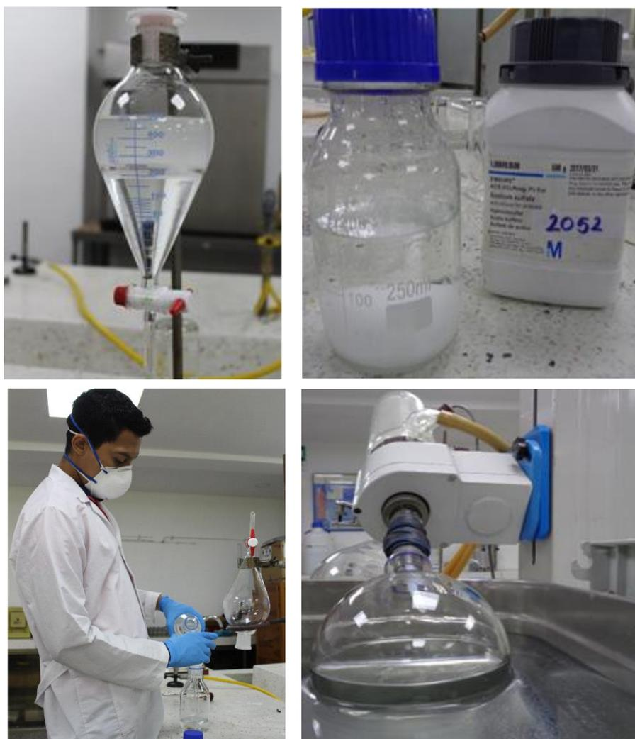
Figura N° 5. 8. Montaje extracción líquido-líquido, secado de fase orgánica y rotavaporación.
