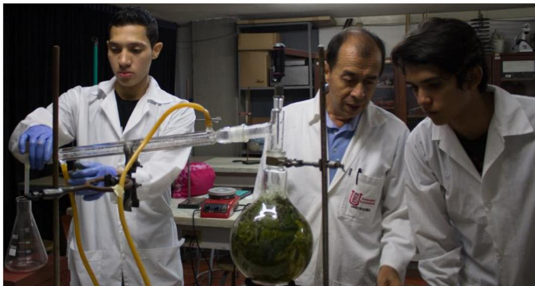
*Figura N° 5. 7. Montaje para Hidrodestilación Simple (HD)*
