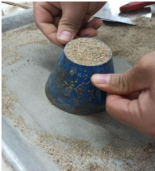
Una vez se haya cumplido la condición, se pesan 500 gramos del agregado para envasarla posteriormente en el picnómetro (S); luego se llena el picnómetro hasta 250 cm<sup>3</sup> para determinar el peso del agua + picnómetro (B). Seguidamente, se vacía el picnómetro, se introduce los 500 gramos de la muestra y se incluye agua hasta 500 cm<sup>3</sup>, el cual se agita con
