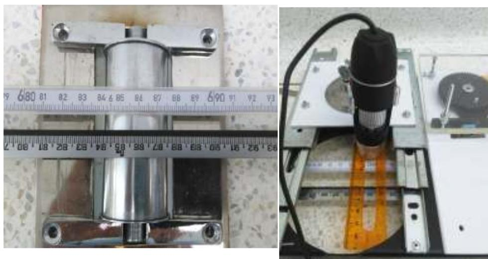
Figura 20. Montaje para la verificación de cinta.
