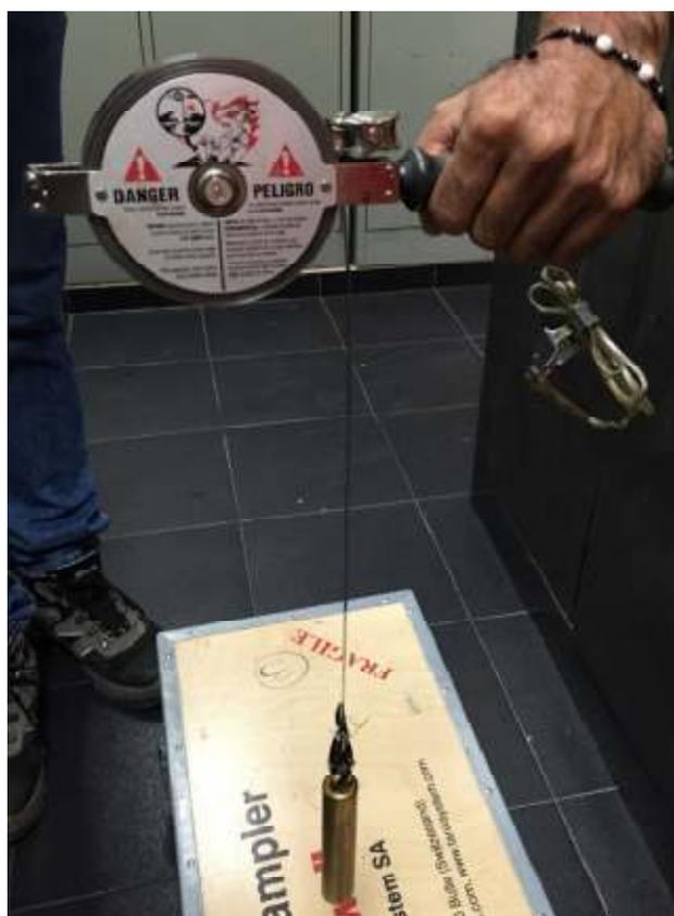
Figura 7. Cinta y plomada para Método a Fondo
