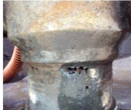
**Figura 8.** Válvula del Cabezal Dañada. **Figura 9.** Parte Inferior del Cabezal Rota.
