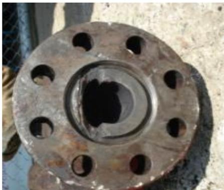
**Figura 10.** Cabezal Corroído.
