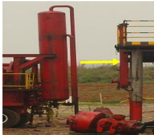
Después de poner la guitarra, se procede a correr la mesa rotaria, para lo que se necesitan dos carromachos. Primero, se deja la mesa más o menos en posición al contrapozo, después se tira solo hacia a un lado, se deja un poco pasada del contrapozo, después se jala del otro lado y así se va colocando en su respectivo lugar. Se debe tener en cuenta la elevación de la segunda sección de la mesa rotaria.
