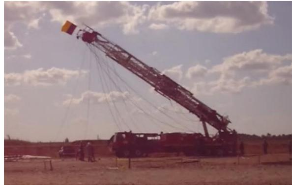
2. Posteriormente se colocan las poleas de los cables de las llaves de potencia ya que las pesas de estas van en la Mesa Rotaria y se necesita desconectarla completamente del la Torre para poder viajar. La Torre debe estar desasegurada de la cabina de la Unidad Básica no de la segunda sección porque de lo contrario, se revienta la cadena que la asegura.
