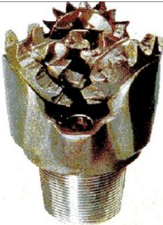
Elemento de corte localizado en el extremo inferior de la sarta de producción que se utiliza para cortar o triturar la formación durante el proceso de la perforación rotaria. Funcionan con base a dos principios: fallar la roca venciendo sus esfuerzos de corte y de compresión.
