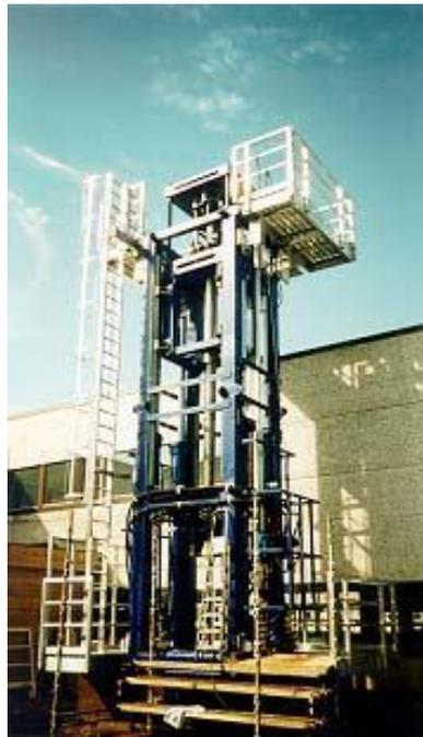
**Ilustración 44: Unidad de Snubbing (equipo de empuje de tubería) (Fuente: Principios De Perforación Bajo Balance y su Aplicación en Campos Geotérmicos. Weatherford; Capitulo 2 / Pág.34)**
