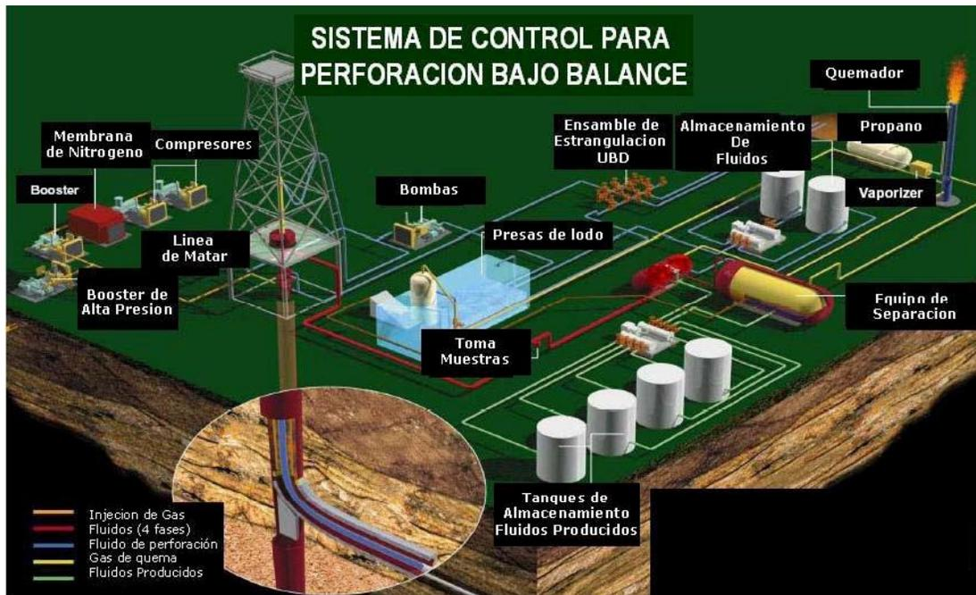
**Ilustración 22: Sistema de control para perforación Bajo Balance (Fuente: Principios De Perforación Bajo Balance y su Aplicación en Campos Geotérmicos. Weatherford); Capítulo 4 / Pág. 46**
