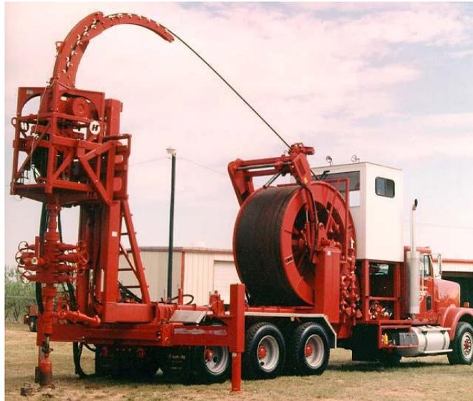
**Ilustración 45: Equipo de tubería flexible (Fuente: Principios De Perforación Bajo Balance y su Aplicación en Campos Geotérmicos. Weatherford Capitulo 2 / Pág. 35)**
