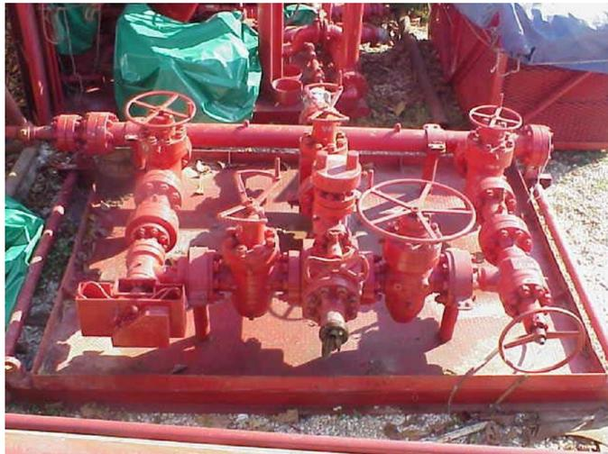
**Ilustración 38: Ensamble de estrangulación 4 1/16” de tres vías & 5000 psi (Fuente: Brochure “Ensamblajes de Estrangulación” Weatherford)**
