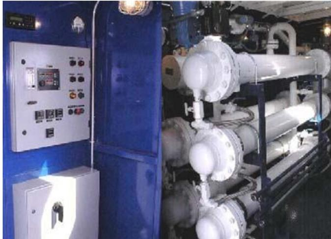
**Ilustración 25: Equipo de generación de Nitrógeno tipo membrana (Fuente: Principios De Perforación Bajo Balance y su Aplicación en Campos Geotérmicos. Weatherford Capítulo 4 / Pág. 50)**
