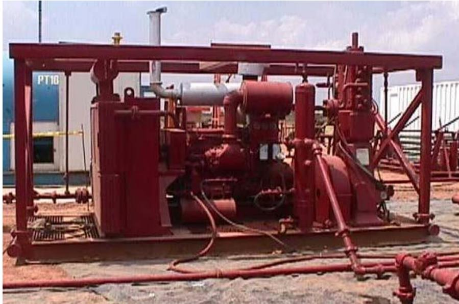
**Ilustración 24: Booster. Compresor elevador de presión. (Fuente: Principios De Perforación Bajo Balance y su Aplicación en Campos Geotérmicos. Weatherford Capítulo 4 / Pág. 50)**
