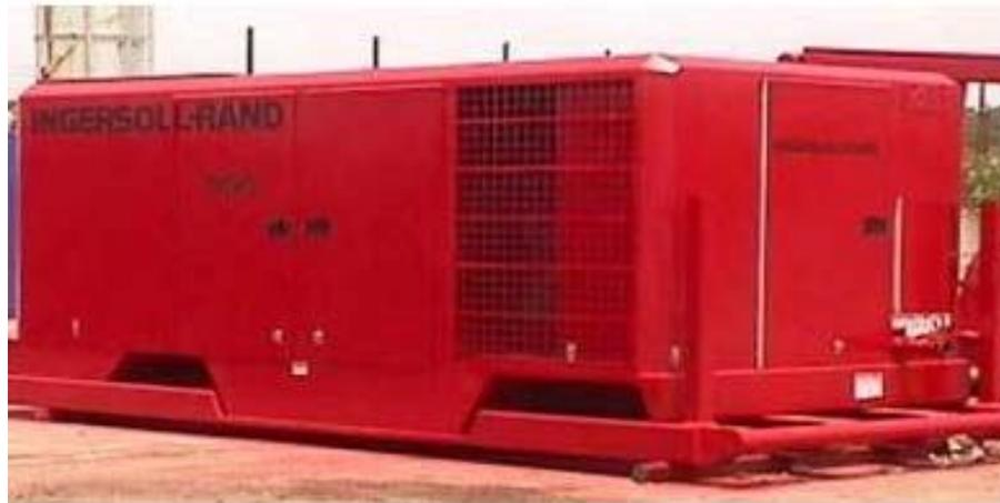
Ilustración 23: Compresor de tornillo rotatorio. (Fuente: Principios De Perforación Bajo Balance y su Aplicación en Campos Geotérmicos. Weatherford); Capítulo 4 / Pág. 49
